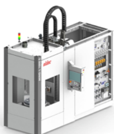
MIND-L 1000 S: Induktionshärtemaschine für große Stückzahlen bei maximaler und gleichbleibender Präzision
